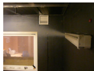
Air diffusion visualisation using fumes
